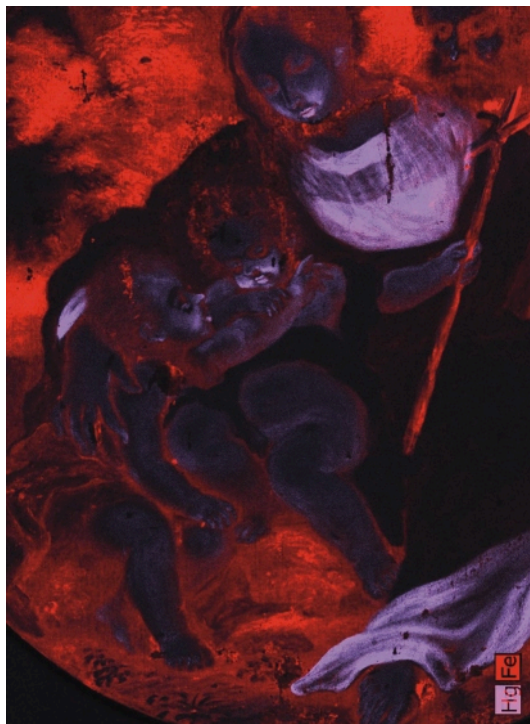
M. de Maio, „Święta Rodzina ze św. Janem”, ok. 1680. Badania wykonane z zastosowaniem wielkoformatowego skanera fluorescencji rentgenowskiej (makro-XRF) M6 JetStream. Mapa rozkładu rtęci(Hg) i żelaza(Fe). Autorka pomiarów: dr Magdalena Iwanicka
