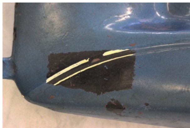
Odkrywka wykonana na zbiorniku paliwa motocykla BMW R4 z widoczną zachowaną warstwą malarsko-lakierniczą, fot. Karolina Machątek
