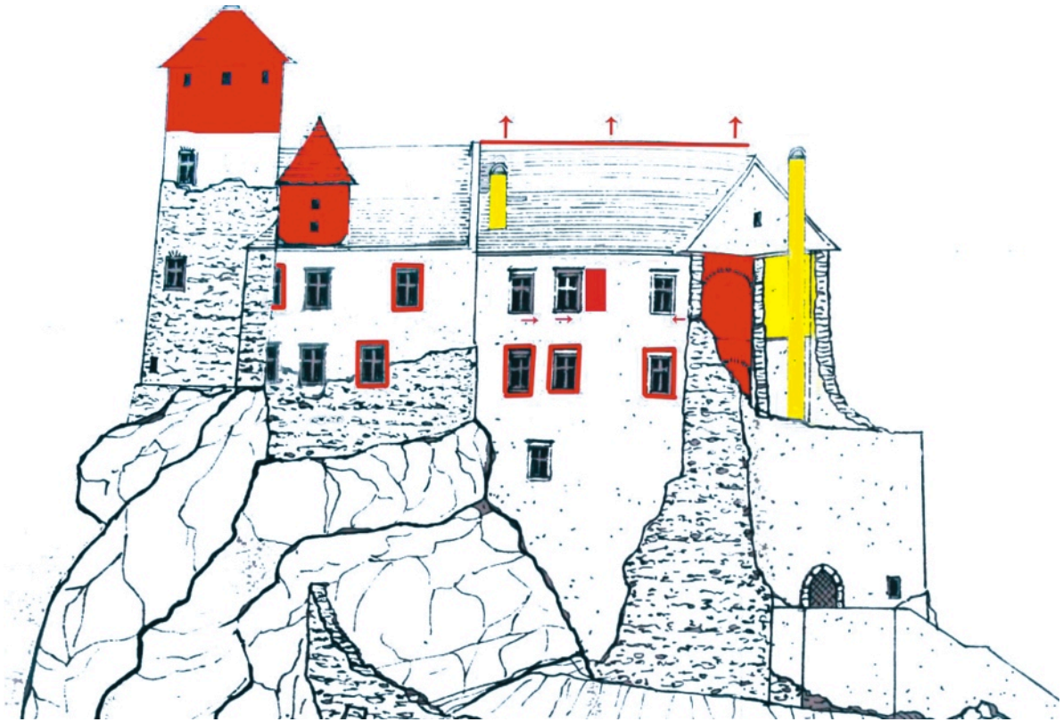
Zamek w Bobolicach. Porównanie próby rekonstrukcji elewacji zamku od strony zachodniej i południowej – dokonanej na podstawie analizy historyczno-ikonograficznej ze stanem zrealizowanym, oprac. Artur Rok
