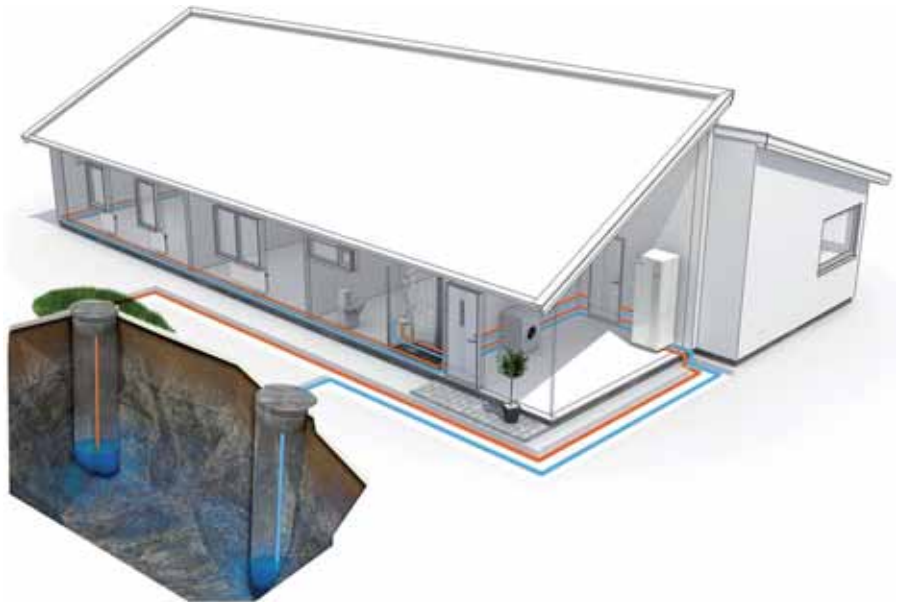
Rys. 6. Układ studni eksploatacyjnej i chłonnej [10]
