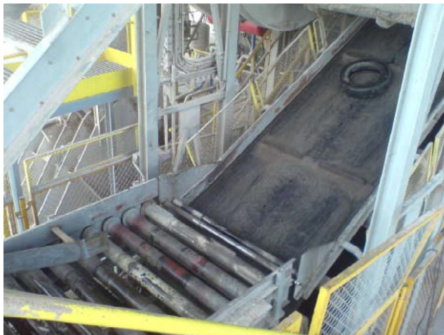
Rys. 4. Fragment instalacji podawania opon – podajnik rolkowy i przenośnik taśmowy [1]
