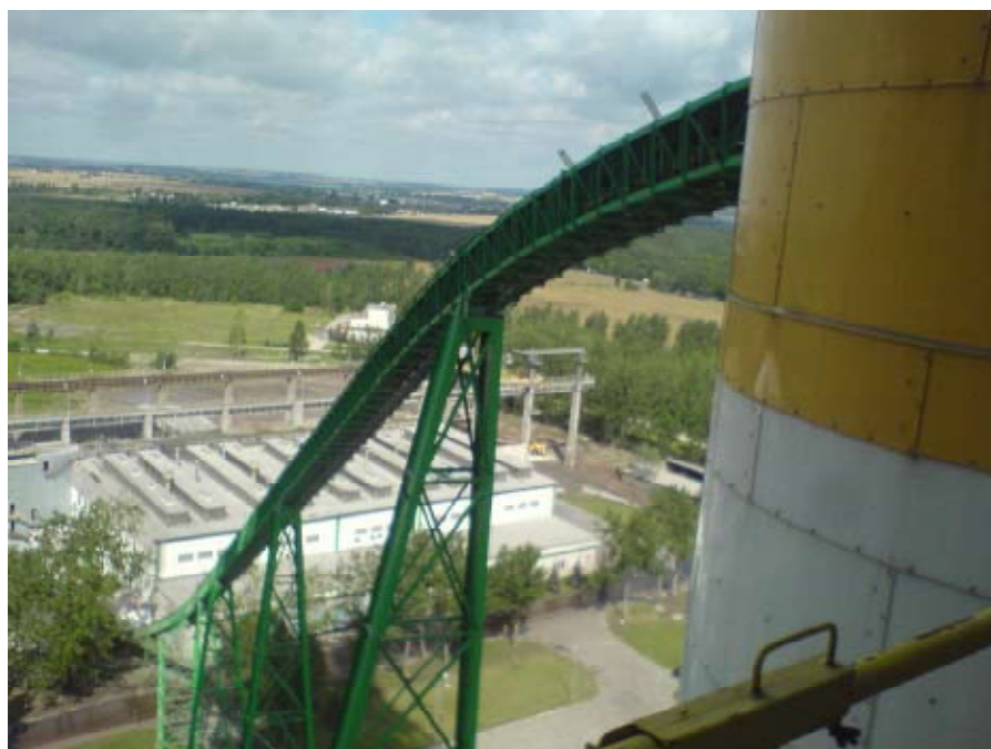
Rys. 3. Fragment przenośnika podającego paliwa PASr do kalcynatora. W dole widoczny magazyn PASr.
