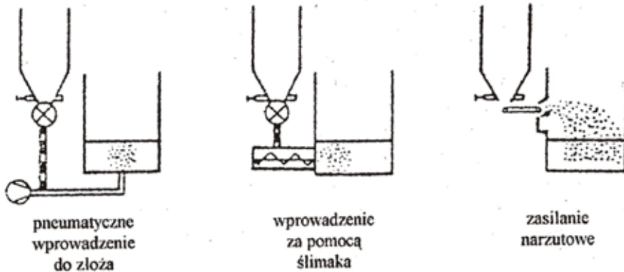
Rys. 4. Wprowadzanie drewna do złoża fluidalnego [36]
