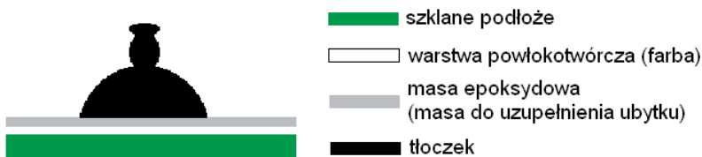
Rys. 2. Schemat przekroju poprzecznego układu do badania przyczepności farb. Rys. Andrzej Podgórski
