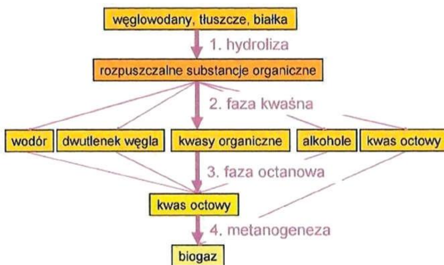
Rys. 12. Etapy fermentacji metanowej.
