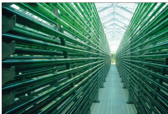
Rys. 11. Hodowla alg w szklarni (fotobioreaktory cylindryczne) [42].
