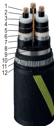
Rysunek 4.2. Schemat kabla morskiego: 1 – żyła miedziana lub aluminiowa do przesyłu energii elektrycznej, 2 – powłoka ekranująca, 3 – izolacja XLPE (usieciowany polietylen), 4 – ekran półprzewodzący, 5 – ekran z miedzianego drutu ze środkiem pęczniącym pod wpływem wilgoci, 6 – laminowana powłoka aluminiowa, 7 – przewody optoelektryczne, 8 – polipropylenowe uzupełniacze, 9 – taśmy wiążące, 10 – podłoże propylenowe pod zbrojenie, 11 – zbrojenie z galwanizowanego drutu, 12 – propylenowa powłoka zewnętrzna ze związkami bitumicznymi
