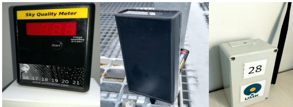
Ryc. 5. Stosowane urządzenia pomiarowe: ręczny fotometr SQM wykorzystany w pierwszym etapie prac (po lewej), widoczny bez zewnętrznej obudowy fotometr SQM w wersji LU wykorzystywany, jako tło pomiarowe (na środku) oraz autorskiej konstrukcji rejestrator jasności powierzchniowej nieba (po prawej) (fot: Dominika Karpińska).
