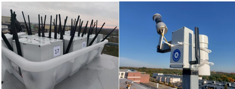
Ryc. 7. Testowanie „chmury” powtarzalnych, autorskich urządzeń pomiarowych (lewo) na tarasie obserwacyjnym WNoZiGP UMK w bliskim sąsiedztwie działającego już w sieci monitoringu urządzenia oraz dodatkowo zamontowanego obok fabrycznego fotometru SQM (prawo) (fot: Mieczysław Kunz).
