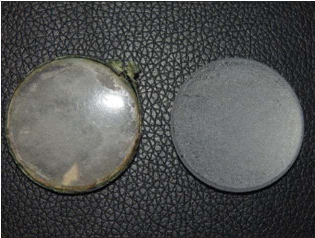
Ryc. 1. Eksperyment porównawczy. Ustalenie mocy soczewek. Po lewej – soczewka do ekspertyzy, po prawej – soczewka zmatowiona przez wykonującego pomiary. Fot. P. Stępniewski
