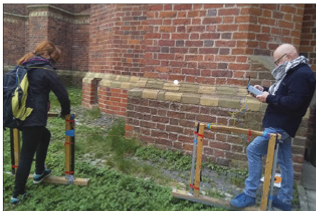
Ryc. 2. Toruń, stan. 360. Badania metodą elektrooporową przy kościele św. Jakuba. Fot. G. Kurczewski
