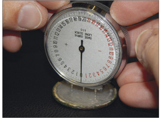
Ryc. 2. Pomiar grubości w środku optycznym. Fot. P. Stępniewski
