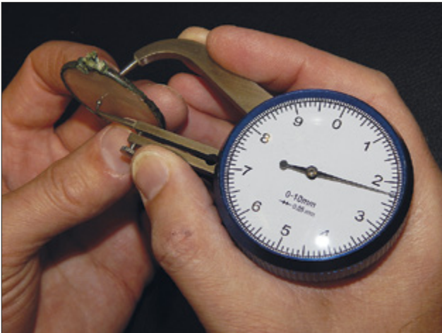
Ryc. 3. Pomiar grubości części nośnej dla oka prawego. Fot. P. Stępniewski
