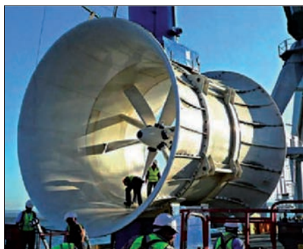
Rys. 31. Turbina z zamkniętymi łopatkami [43]
