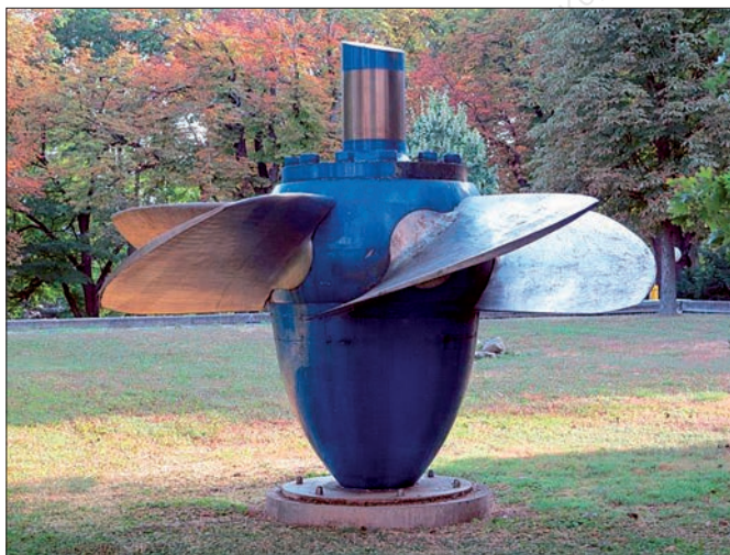
Rys. 6. Turbina Kaplana w Muzeum Techniki we Wiedniu (fot. Raum Rein)
