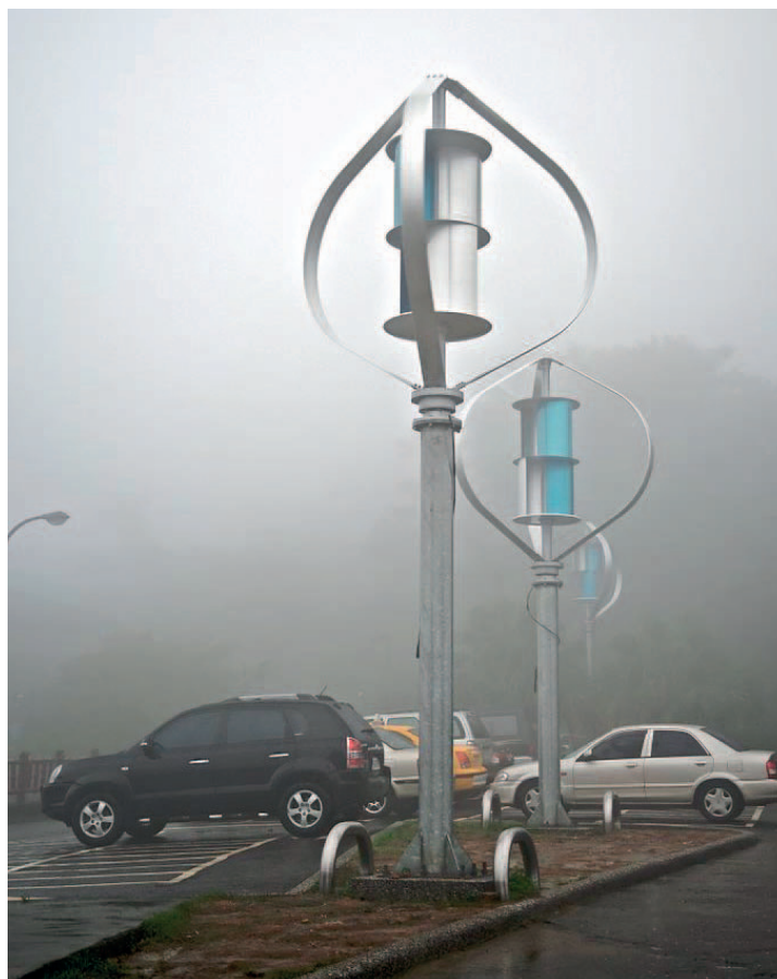
Il. 7. Turbina będąca połączeniem turbiny Darrieusa i Savoniusa, Tajwan (fot. Fred Hsu [7])
