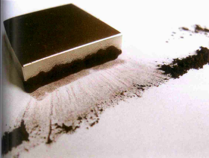
Przykład intensywnego, obfitego przyciągania przez magnes neodymowy pigmentu zawierającego żelazo (czerwień żelazowa)
