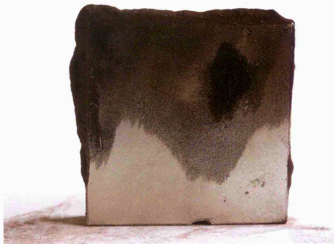
Powierzchnia magnesu neodymowego po kontakcie z pigmentem zawierającym żelazo
