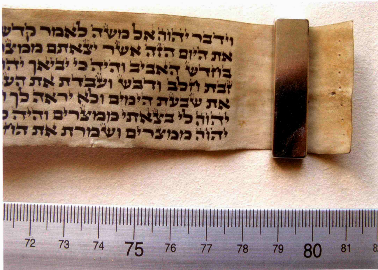
1 Przykład zastosowania magnesu neodymowego przy zabiegach na zwojku pergaminu żydowskiego (z tefilin). Magnes uniemożliwia zwijanie się obiektu przy wykonywanych zabiegach
