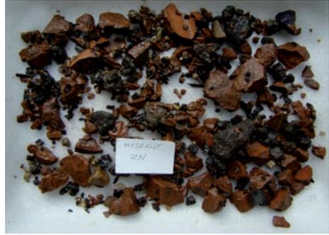
Fig. 4. Hydralit ZN – gravel fraction
