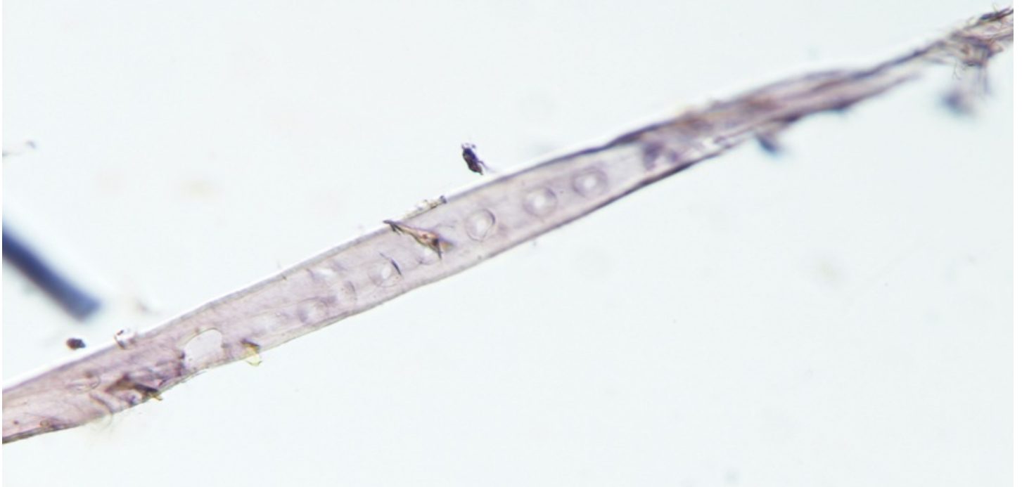
Masa celulozowa z drewna iglastego w odczynniku Herzberga Softwood pulp in Herzberg stain
