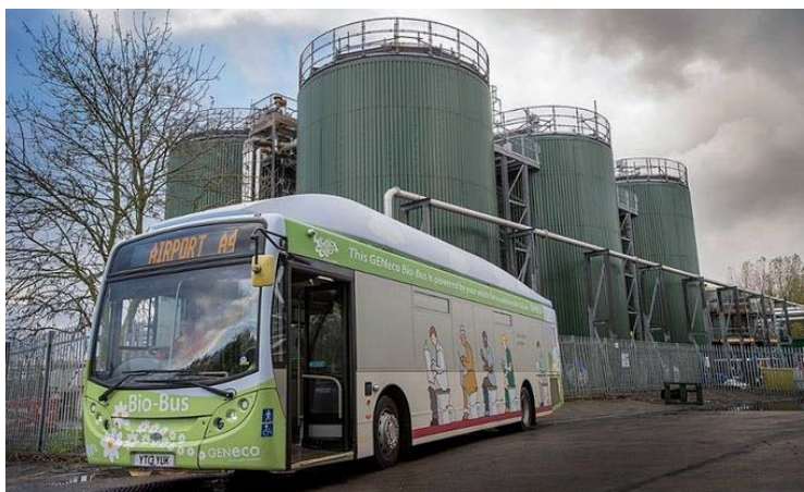
Rycina 24. Bio-Bus jest zasilany biometanem generowanym z ludzkich odchodów i odpadów żywnościowych
