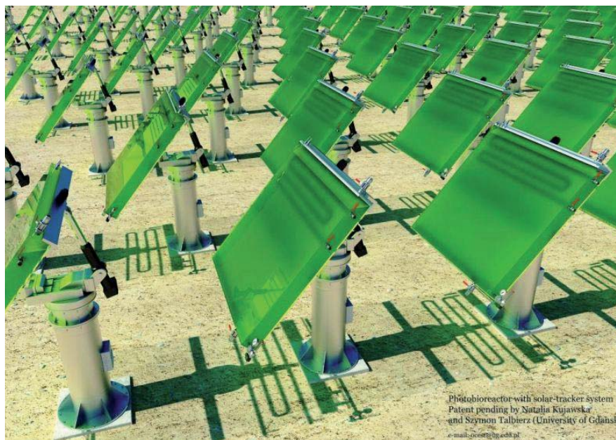
Rycina 22. Fotobioreaktor skonstruowany przez naukowców z Uniwersytetu Gdańskiego
