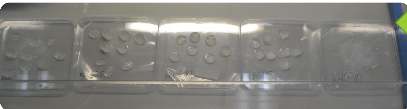
Rys. 9. Seria próbek kolagenowych z 5% dodatkiem hydrolizatów elastyny.
