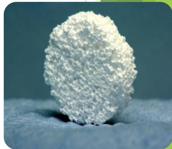
Rys. 1. Skafold wykonany z fosforanu wapnia.
