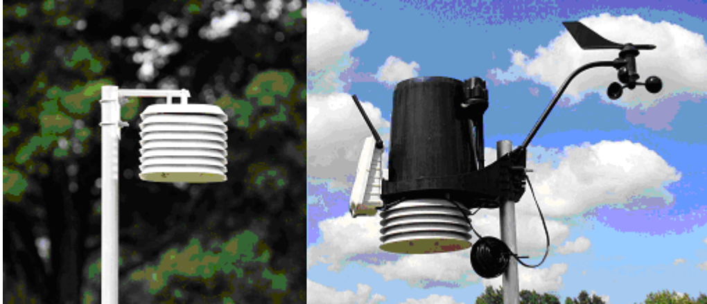
Rys. 2. Termiczno-wilgotnościowe czujniki firmy MadgeTech (lewe zdjęcie) i automatyczna stacja meteorologiczna firmy Davis (prawe zdjęcie)
