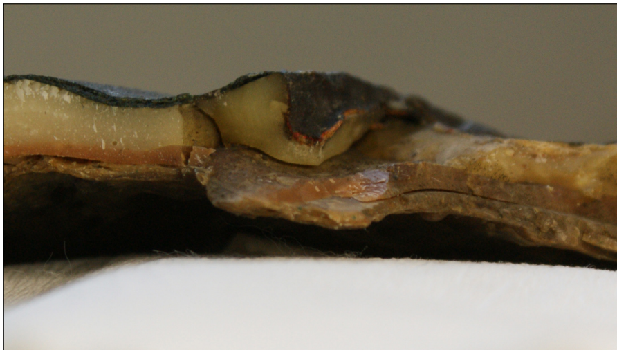
Il. 9. Wyraźnie widoczna trójwarstwowa struktura woskowego odlewu: każda z kolejnych warstw wlewanego w formę wosku różni się od poprzedniej klasą czystości i jakości, fot. M. Pilarska
