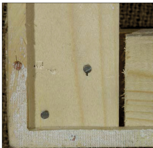
Fot. 6. Faza otrzymana przez nabicie listewek po obwodzie krosien z zaprawą na bazie poliocyanu winylu, która przesączyla się przez płótno i skleila je z listewkami, utrudniając zdjęcie go z krosien, fot. M. Wachowiak
