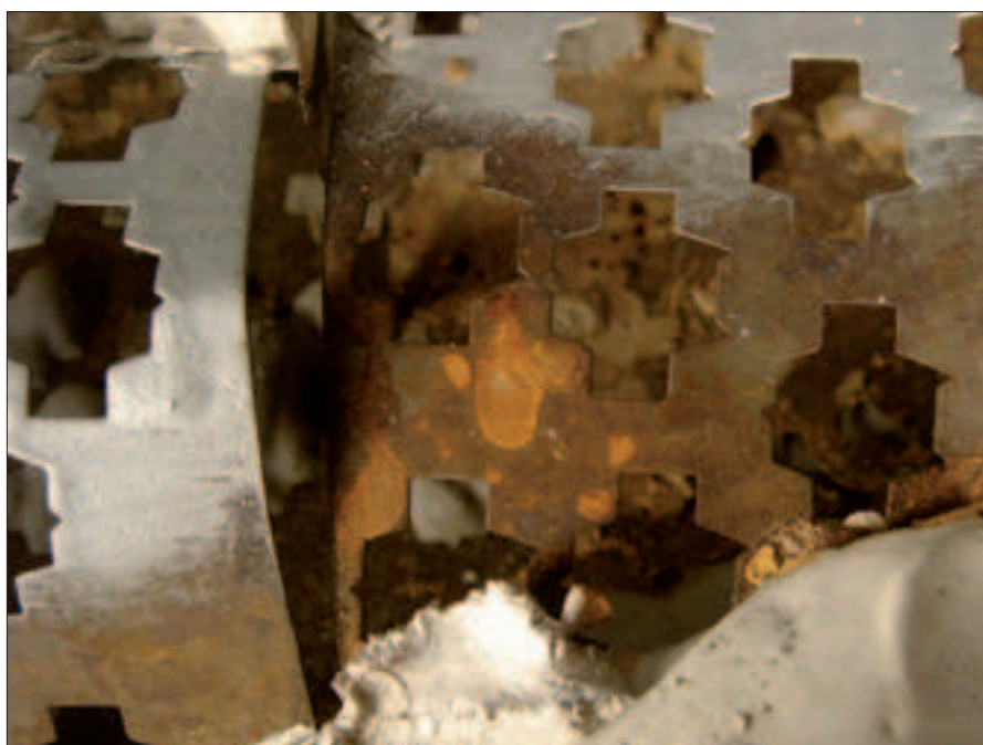
Il. 5. Bronisław Kierzkowski, Kompozycja fakturowa nr 532 , fragment, widoczne jasnopomarańczowe, świeże ogniska korozji
