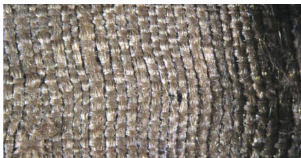
Ryc. 41. Układ wątku i osnowy w tkaninie nr kat. 20, czytelny brzeg tkaniny, powiększenie 10×
