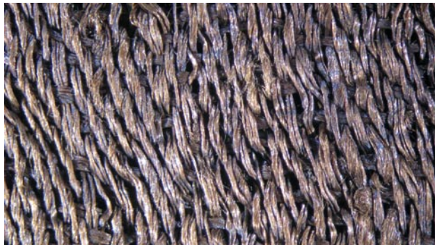
Ryc. 26. Układ wątku i osnowy w tkaninie nr kat. 11, powiększenie 10 \times
