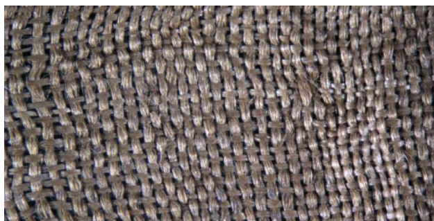
Ryc. 47. Układ wątku i osnowy w tkaninie nr kat. 27, powiększenie 10×
