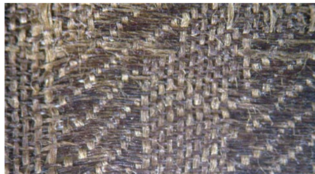
Ryc. 30. Układ wątku i osnowy w tkaninie nr kat. 14, powiększenie 10× Fig. 30. Weft and warp composition in textile cat. No. 14, enlargement 10×
