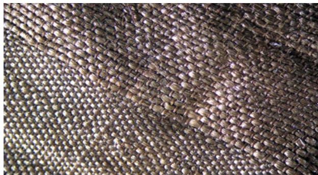
Ryc. 37. Układ wążku i osnowy w tkaninie nr kat. 18, powiększenie 10 \times
