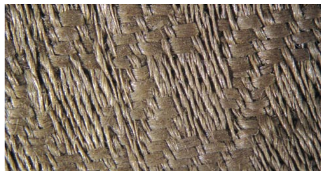
Ryc. 8. Układ wążku i osnowy w tkaninie nr kat. 1, powiększenie 10 \times Fig. 8. Warp and weft composition in textile cat. No. 1, enlargement 10 \times
