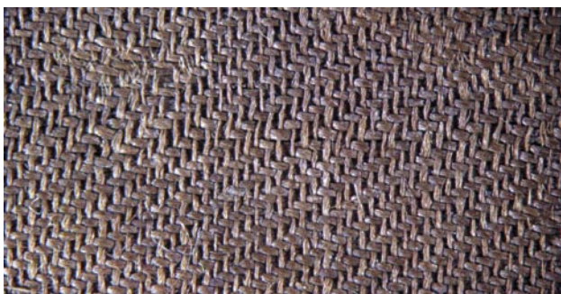
Ryc. 18. Układ wątku i osnowy w tkaninie nr kat. 7, powiększenie 10×
