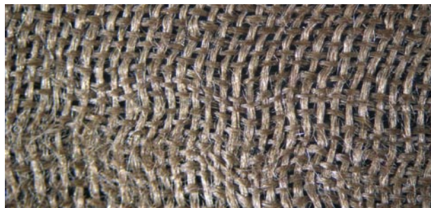
Ryc. 43. Układ wątku i osnowy w tkaninie nr kat. 22, powiększenie 10×
