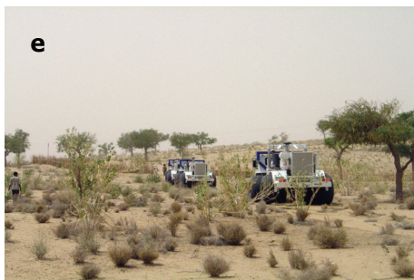
Rys. 3. Etapy prac sejsmicznych: a) wyznaczanie linii wzbudzania przez zespół geodetów, b) rozłożona linia odbioru (geofonowa), c) spychacze przygotowujące podjazdy pod wydmy dla wibratorów, d) samojezdne urządzenie wiertnicze służące do wiercenia profili (sond), e) wibratory w pracy terenowej, f) wypłata rekompensat za straty uprawowe
