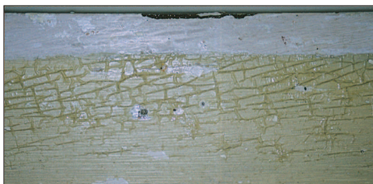
Fot. 4. Silne spęcherzenia i odspojenia warstwy polichromii 43 , powstałe w wyniku zanurzenia w 10% roztworze Paraloidu B-72, zarówno w toluenie, jak i w 1-metoksy-2-p-ropanolu (fot. K. Szczepińska)
