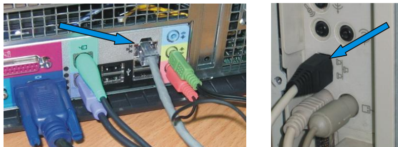
Rys.1 Tylne panele obudów komputerów z widocznymi gniazdami kart sieciowych oraz podłączonymi kablami UTP zakończonymi wtyczkami RJ45.
