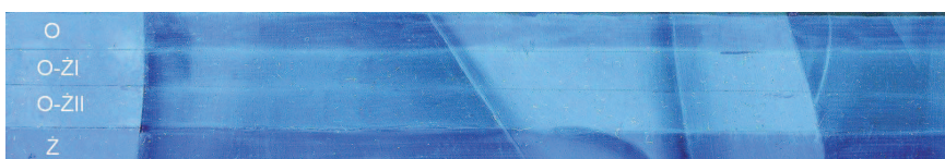
Il. 21. Lak berberysu zwyczajnego na substracie \text{PbSO}_4 (w spoiwie olejnym „O”, dwóch olejno-żywicznych „O-Z” oraz żywicznym „Z”)
