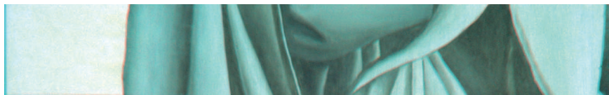
Il. 11c. Lak rezedy żółtawej na substracie \text{CaSO}_4 \times 2\text{H}_2\text{O} ze spoiwem olejnym w kolorowej podczerwieni (fot. A. Cupa, J. Rogóż)
