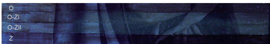
Il. 3b. Lak aloesu na substracie \text{CaSO}_4 \times 2\text{H}_2\text{O} ze spoiwami: olejnym, olejno-żywicznym (2 \times ) oraz żywicznym w ultrafiolecie (fot. A. Skowroński)
