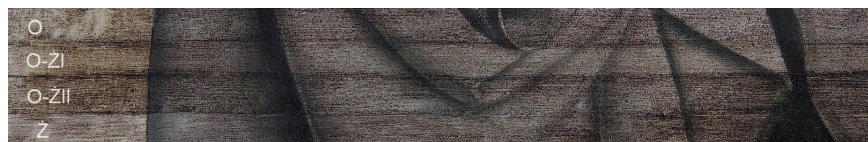
Il. 10a. Lak aloesu na substracie \text{Al}(\text{OH})_3 ze spoiwami: olejnym, olejno-żywicznym (2 \times ) oraz żywicznym w świetle widzialnym (fot. A. Skowroński)
