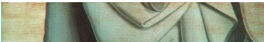
Il. 63. Lak kory szakłaku pospolitego na substracie \text{Al}(\text{OH})_3 (w reakcji nr 4) w spoiwie olejnym
