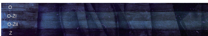
Il. 42. Lak aloesu drzewiastego na substracie \text{Al}(\text{OH})_3 (w reakcji nr 4) (w spoiwie olejnym „O”, dwóch olejno-żywicznych „O-Z” oraz żywicznym „Z”)
