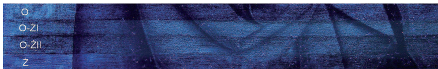
Il. 40. Lak aloesu drzewiastego na substracie \text{CaSO}_4 \times 2\text{H}_2\text{O} (w spoiwie olejnym „O”, dwóch olejno-żywicznych „O-Z” oraz żywicznym „Z”)
