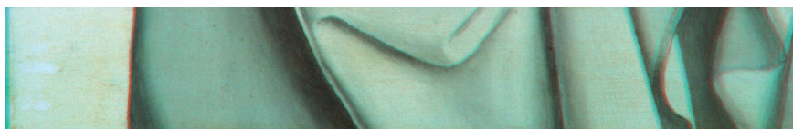
Il. 70. Lak jagód kruszyny pospolitej na substracie \text{Al}(\text{OH})_3 (w reakcji nr 3) w spoiwie olejnym
