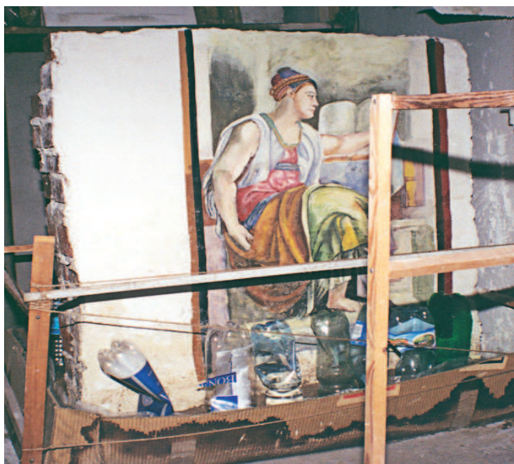
Il. 5. Model imitujący malowidła ściienne w technice występującej w Polsce poddany kapilarnemu zawilgacaniu (fot. S. Lim)
