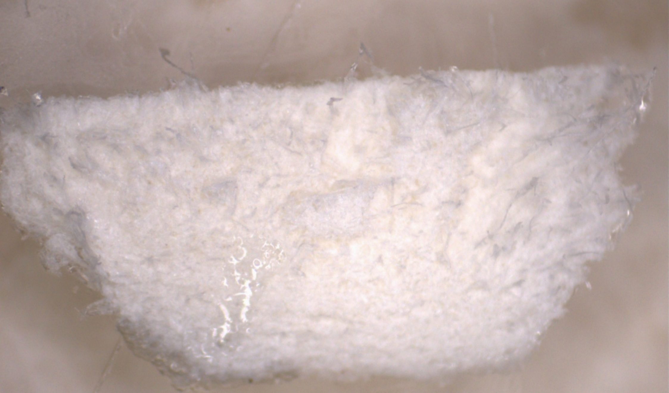
Wygląd próbki papieru przed reakcją, mikroskop stereoskopowy, światło VIS, odbite, 20 ×
