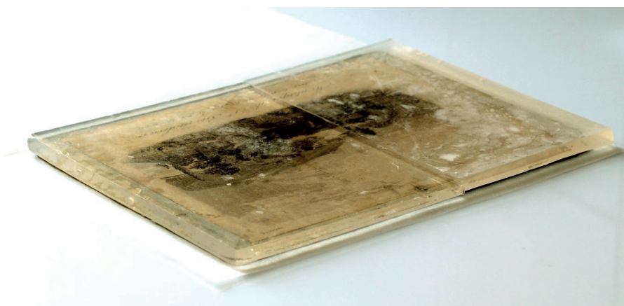
Fot. 6. Arkusze gumy gellan naniesione bezpośrednio na lico ryciny naklejonej na tekturowe podłoże. Fot. Dominika Wojciechowska
