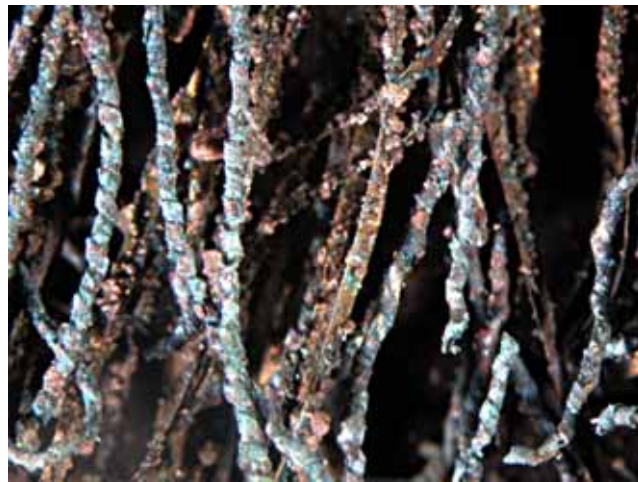
Ryc. 3. Zdjęcie pod mikroskopem (powiększenie 10×), widoczny metalowy oplot i płaska taśma (fot. D. Grupa)
