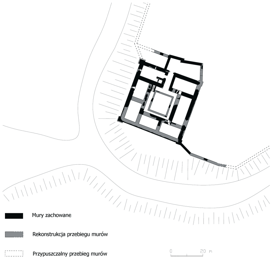
Ryc. 3. Papowo Biskupie, gm. loco. Rekonstrukcja zamku górnego po badaniach w 2012 roku (oprac. B. Wasik)
