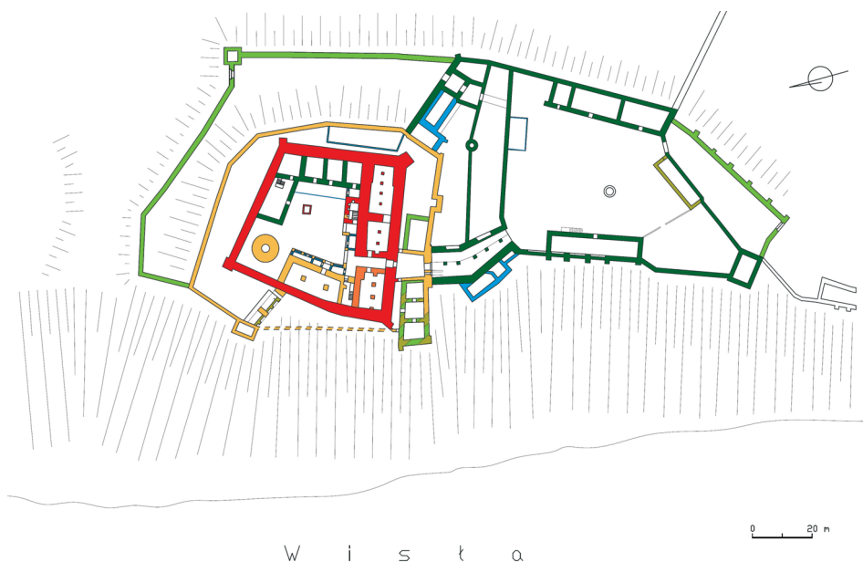
Ryc. 9. Grudziądz. Rekonstrukcja etapów budowy zamku i przedzamcza (oprac. B. Wasik)
