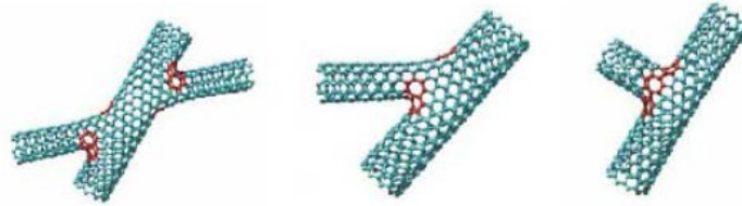
Rys. 41. Modele połączeń nanorurek węglowych odpowiednio „X”, „Y” oraz „T”, kolorem czerwonym oznaczono pierścienie 5/7; rysunek zaczerpnięto z [20].
