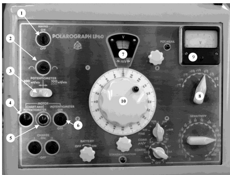
Schemat III. Panel przedni potencjostatu z numeracją elementów sterowania wykorzystaną w opisie obsługi.
